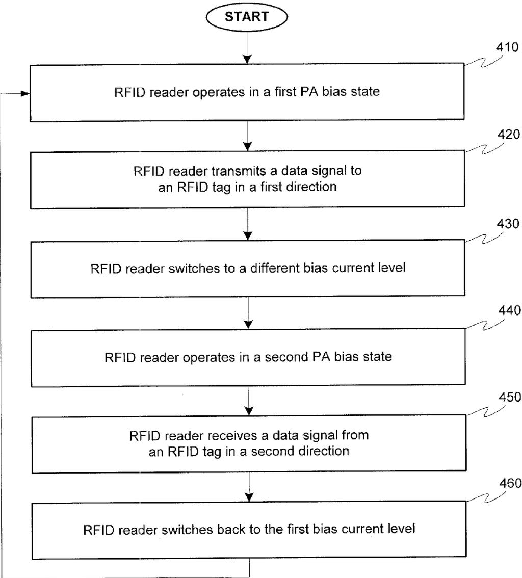
**METHOD AND SYSTEM FOR VARIABLE POWER AMPLIFIER BIAS IN RFID TRANSCEIVERS**
