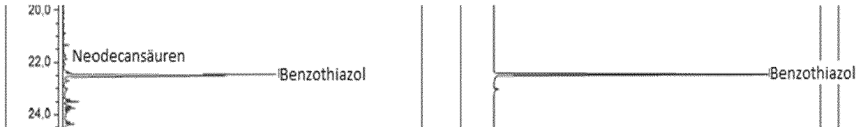
Abb. 1b Gummimehl kryogen gemahlen, plus 2% PPA 115%, rechts Benzothiazol-Peak extrahiert
