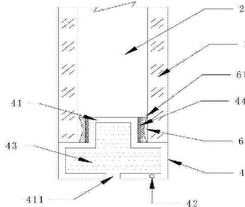
1. 一种隔热保温玻璃,其特征在于:包括玻璃和二氧化硅气凝胶板片,所述玻璃和二氧化硅气凝胶板片安装在外框支架上,所述玻璃的至少一面上设置有至少一片二氧化硅气凝胶板片,所述外框支架设置有空腔,所述空腔中填充有隔热体。
