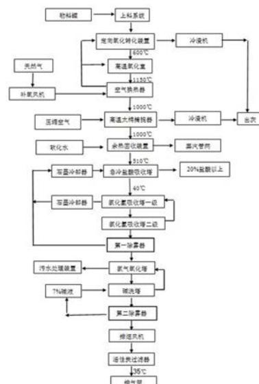
1. 有机硅高沸混合液定向转化系统,其特征在于,包括依次设置的定向氧化转化装置、高温氧化室、补氧风换热器、高温太棉捕捉器、余热回收装置、急冷盐酸吸收塔、氯化氢吸收塔一/二级、氯气氧化塔、碱洗塔、排烟风机、活性炭过滤器、排气筒;
