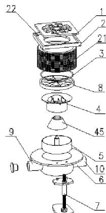
1. 一种可密封防臭盖的高水封内芯式排水控制装置,包括:两侧安装有进水管和排水管的地漏壳体,以及依次安装在地漏壳体内环状凸台上的防臭座和防臭盖,与壳体相配合的面板座,以及与面板座配合安装的格栅盖板,
