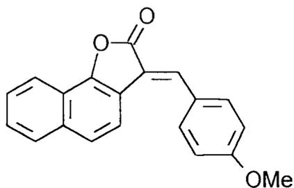
45 Eine Mischung aus 2,76 g des Naphthofuranons aus Beispiel 4, 2,04 g 4-Methoxybenzaldehyd, 0,2 ml Piperidin und 30 ml Toluol wird 2 Stunden am Wasserabscheider unter Rückfluß erhitzt. Nach einigen Stunden wird der Niederschlag abgesaugt und mit Methanol gewaschen. Ausbeute: 3,3 g.
