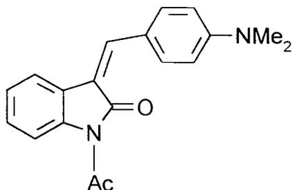
15 Eine Lösung von 2,0 g 2-Indolon, 2,3 g 4-Dimethylaminobenzaldehyd, 12,5 ml Acetanhydrid und 10,0 ml Essigsäure wird 4 Stunden unter Rückfluß erhitzt und anschließend unter vermindertem Druck vom Lösungsmittel befreit. Der Rückstand wird in 50 ml Methanol 15 Minuten unter Rückfluß erhitzt. Der entstandene Niederschlag wird bei 60 °C abgesaugt und mit Methanol gewaschen. Ausbeute: 3,2 g.
