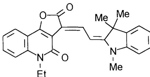
3,7 g des Chinolons aus Beispiel 11, 3,16 g des Aldehyds aus Beispiel 3, 20 ml Eisessig und 25 ml Acetanhydrid werden 30 Minuten unter Rückfluß erhitzt. Das beim Abkühlen ausfallende Produkt wird abgesaugt, mit Eisessig und Aceton gewaschen und bei 70 °C im Vakuum getrocknet. Ausbeute: 5,5 g.
