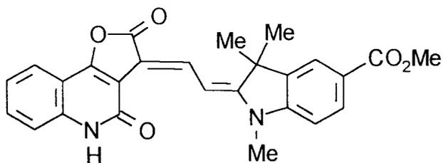
15 1,3 g des Chinolons aus Beispiel 9, 2,0 g des Aldehyds aus Beispiel 2, 10 ml Eisessig und 12,5 ml Acetanhydrid werden 30 Minuten unter Rückfluß erhitzt. Anschließend saugt man den Niederschlag kalt ab und wäscht mit Methanol nach. Ausbeute: 2,4 g.
