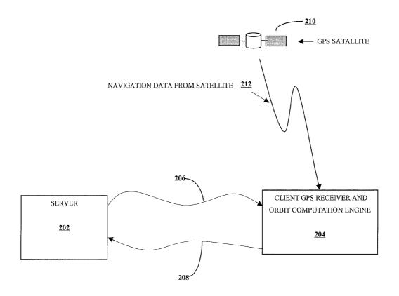
FIG 2 SERVER - CLIENT COMMUNICATION SYSTEM
