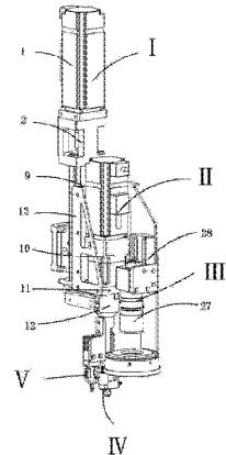
1. 一种自动对位零件安装机构,其特征在于:它包括起升降作用的驱动装置、起旋转作用并安装零件的零件安装机构和起校准作用的校准机构;
