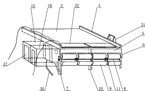
1、一种低落差水位水力发电装置，其特征是，它包括设在江河流水(1)上位处的导流装置，设在江河流水(1)下位处的工作室，工作室设有的发电机(2)，其中所述的导流装置包括设在江河流水(1)上位处的上底面呈阶梯形的导流板(3)，导流板(3)相对的两端上设有的与江河流水(1)方向相平行的侧板(4)，导流板(3)边缘处设有的沿板(5)，所述的沿板(5)两端上分别设有的支架(6)下设有相应的支撑架(7)，所述的支撑架(7)之间至少设有一个转轴(8)，转轴(8)与支撑架(7)之间设有轴承，转轴(8)上至少设有两个水车组，每个水车组至少由两个水车(9)组成，每两个相邻的水车组之间的转轴(8)上设有的轴承设在上端位于导流板(3)上的立柱(10)上，每两个相邻的水车(9)之间设有伞齿轮(11)，每个伞齿轮(11)均连接有能够改变动力方向的转向伞齿轮(12)，转向伞齿轮(12)上设有伞齿轮连接轴(13)，所述的支撑架(7)上设有角形支架(14)，所述的伞齿轮连接轴(13)设在角形支架(14)内设有轴承上，
