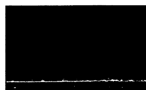
C O 2 MODIFICATION 5[min] \theta = 11.1^\circ
