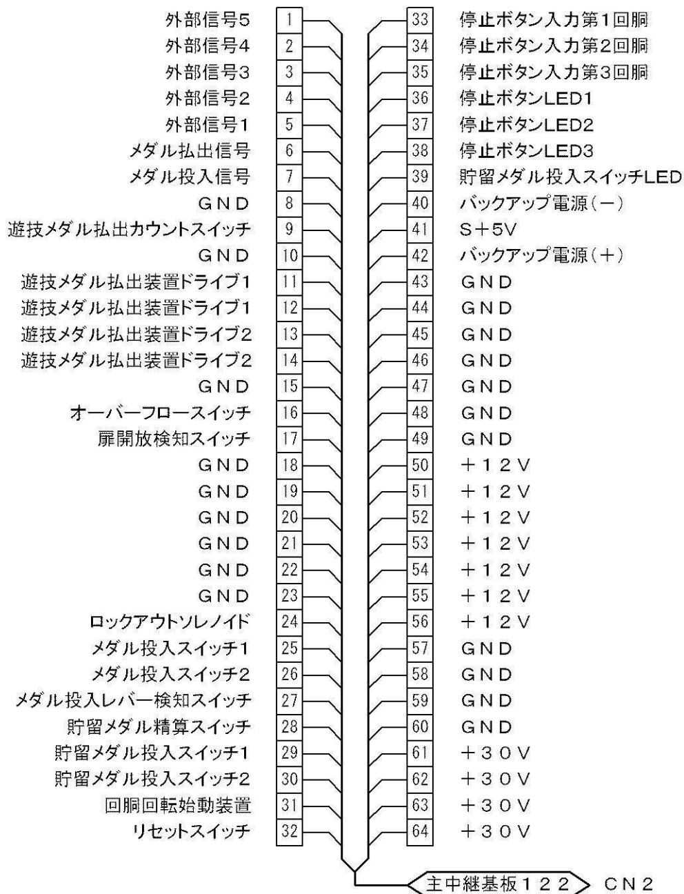
主制御基板409のCN1の64ピン
