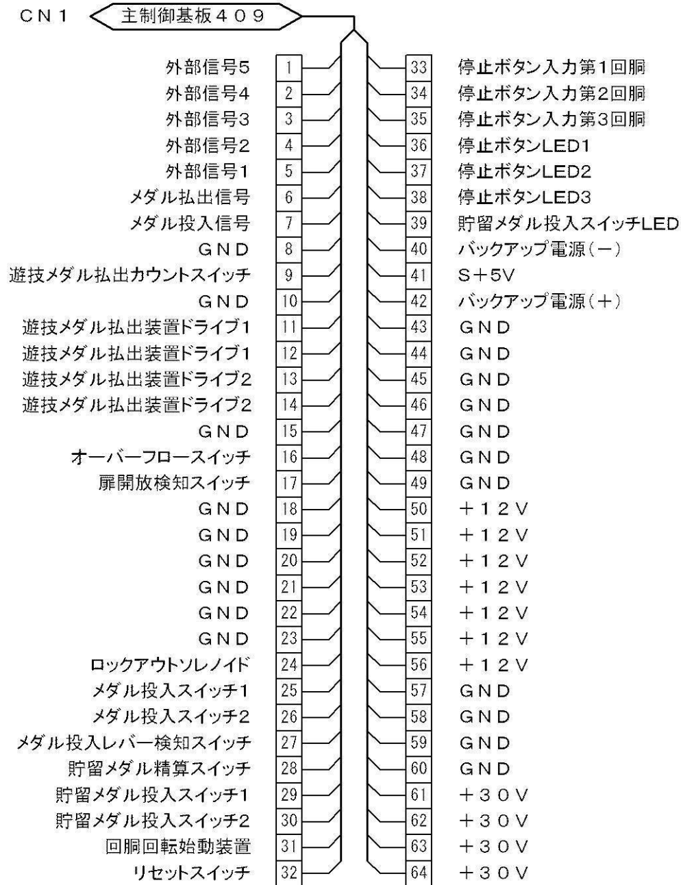
主中継基板 1 2 2 の CN 2 の 6 4 ピン
