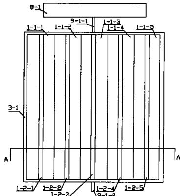
1. 一种抛物柱面聚光空心圆柱体采光太阳能热电采光装置，由长方形箱体、水箱、冷水管、热水管、平面透明盖板和太阳能聚光接收机构构成，各太阳能聚光接收机构都由一块抛物柱面反光镜和一个光能接收器构成，各太阳能聚光接收机构的光能接收器由一根长直的圆柱面空心导热管和一块长直的圆柱面太阳能电池板构成，其特征是：各光能接收器的圆柱面太阳能电池板紧密粘合在该光能接收器的圆柱面空心导热管的表面上，各太阳能聚光接收机构光能接收器的圆柱面太阳能电池板正对该太阳能聚光接收机构的抛物柱面反光镜的反光面，各太阳能聚光接收机构的圆柱面空心导热管的轴线与该太阳能聚光接收机构的抛物柱面反光镜的焦线相互重合，各太阳能聚光接收机构的圆柱面空心导热管对称的位于该太阳能聚光接收机构的抛物柱面反光镜的对称面的两侧，
