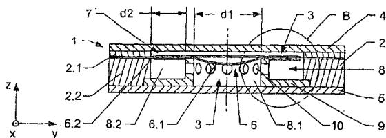
1. 一种光学系统 (1, 20, 27, 49, 65), 包括具有在轴向方向 (z) 上延伸的开口 (3, 67, 93) 的壳体 (2, 13, 28, 50) 和至少一个膜 (6, 21, 22, 59), 所述至少一个膜被布置为穿过开口 (3, 67, 93), 在壳体 (2, 13, 31, 41, 50, 56) 的内部处限定填充有通常恒定量的流体的至少一个腔室 (7, 8, 14, 15, 29, 30), 由此, 该膜包括光学活性和光学惰性部分 (6. 1, 6. 2, 96, 97, 98) 和至少一个致动器 (11, 12), 以通过流体的再定位而影响膜 (6, 21, 22, 29) 的光学活性部分的几何结构, 从而改变光学系统 (1, 20, 27, 49, 65) 的光学特性。
