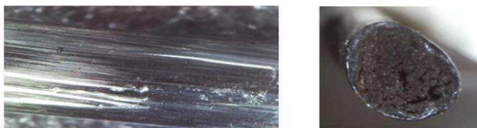
탄소섬유 열가소성 TPU 수지 코팅된 현미경 사진 ( 좌: 측면 우:단면 )
