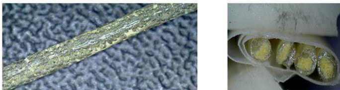
파라아라미드섬유 열가소성 TPU 수지 코팅된 현미경 사진 ( 좌: 측면 우:단면 )
