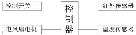
1. 一种全自动电风扇,包括电风扇主体和电风扇电机,其特征在于:其还包括控制器、红外传感器、温度传感器和控制开关,所述控制器分别与所述红外传感器、所述温度传感器、所述控制开关和电风扇电机电连接,所述控制器包含一延时开关,并且所述红外传感器和温度传感器的采样时间间隔小于所述延时开关的延时。
