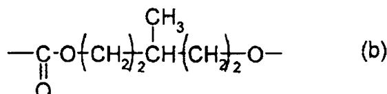
該表面層は、該カーボンブラックを該ポリウレタン樹脂の100質量部に対して18質量部以上30質量部含有し、かつ、該表面層の膜厚をt、該表面層の表面をX、該表面層の表面からの深さがt/4の位置をYおよび該表面層の表面からの深さがt/2の位置をZとしたときに、下記式(1)乃至(4)を同時に満たすことを特徴とする現像ローラ：
