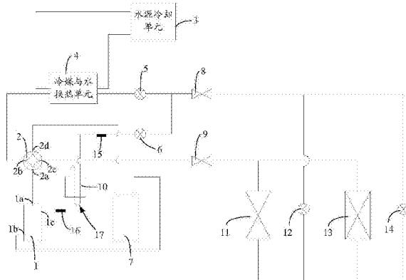
1. 一种多联机空调系统，其特征在于，包括一个空调室外机和至少两个并联的空调室内机，所述空调室外机包括喷气增焓压缩机、四通阀、水源冷却单元、冷媒和水换热单元、室外机液侧截止阀、室外机气侧截止阀和室外机电子发热元件；
