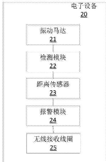
1. 一种电子设备，其特征在于，包括振动马达和检测模块，所述电子设备可放置在无线充电底座上进行无线充电，所述检测模块用于检测所述电子设备与所述无线充电底座的充电效率，当所述充电效率低于预设值，所述振动马达启动以校准所述电子设备与所述无线充电底座的位置。
