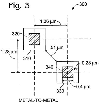
METAL-TO-METAL DESIGN RULES = 0.52 μm Sep. 10, 2002
