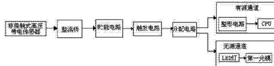
1. 一种有源无源双模感应高压带电显示装置,其特征在于:包括非接触式高压带电传感器;所述非接触式高压带电传感器的输出端依次经整流桥、贮能电路与一触发电路连接;所述触发电路输出端经一分配电路一路连接到无源通道,另一路连接到有源通道;所述无源通道包括第一 LED 灯和第一光耦;所述第一 LED 灯的正极与所述分配电路的第一输出端连接;所述第一 LED 灯的负极与所述第一光耦的正输入端连接;所述光耦的负输入端接所述整流桥的负端;所述有源通道内,所述分配电路的第二输出端输出的信号经第二光耦,并整形后送入 CPU 处理器进行处理、输出显示。
