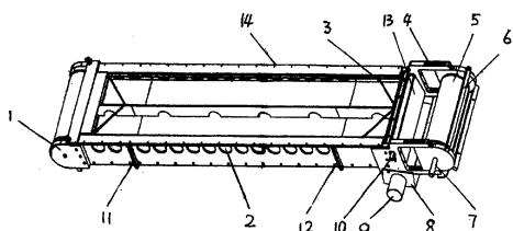
1. 一种微细固液分离机，由从动轮、侧面出水口、滤带支撑架、主动轮伸缩调节头、主动轮、挡板、电机传动轴、积污槽、排污管、高压喷头、滤带清洗舱和滤带组成，其特征在于：主动轮、从动轮与滤带相连接，积污槽与排污管相连接，滤带背面的滤带清洗舱内设有清洗喷嘴；滤带的背面置有高压清洗喷头；在正反滤带之间设有挡板。
