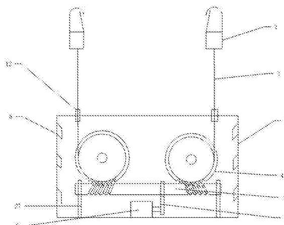
1. 一种电工可背负式自解锁升降工具包，包括有动力机构底座和行程开关，所述的动力机构连接在底座上，所述动力机构上设有两根背带，所述的动力机构内还包括有两个涡轮，所述两个涡轮与蜗杆连接，所述的蜗杆的两端各连接有一个支架，所述蜗杆与电机连接的齿轮啮合，所述涡轮上各连接有一根绳索，所述两根绳索的端部各连接有一个挂钩体，所述的挂钩体上设有挂钩和止卡，其特征在于：所述的挂钩体包括有自伸缩机构以及与挂钩底部连接的挂钩滑轮，所述挂钩滑轮上连接有一根挂绳，所述挂钩体还包括锁体以及设在锁体上的滑槽，所述挂钩滑轮在滑槽内滑动，缓慢拉动绳索时，能够同时拉动挂绳的动作，从而拉倒挂钩，让挂钩从电缆上脱落，所述的动力机构上还连接有一个工具包。
