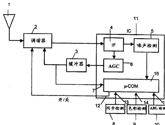
1. 一种自动打开 / 关闭用于放大电视调谐器 (2) 中的微弱视频信号的低噪声放大器的方法, 其特征在于, 该方法包括 :
