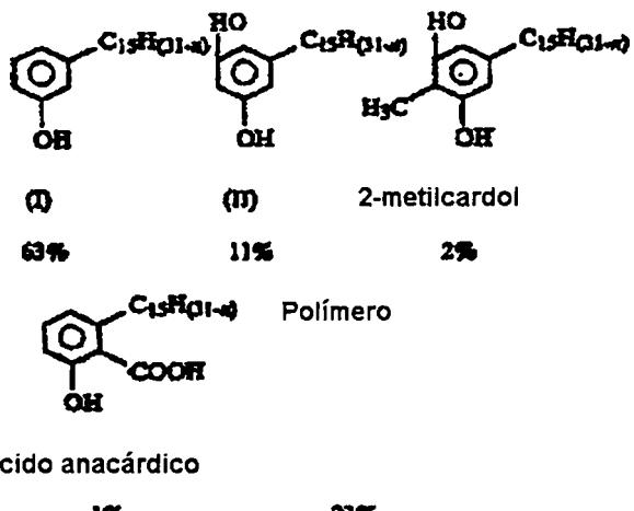
Las cadenas laterales que son saturadas o insaturadas en cis pueden reaccionar posteriormente mediante polimerización hasta compuestos de alto peso molecular ("polímeros").
