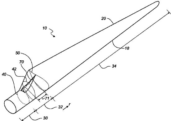
1. 一种用于风力涡轮机(2)的转子的叶片(10),该转子具有基本水平的转子轴,所述转子包括毂(8),当被安装于所述毂(8)时所述叶片(10)从所述毂(8)基本沿径向方向延伸,所述叶片具有带尖端(16)和根部端(14)的纵向方向(r)以及横向方向,所述叶片还包括:
