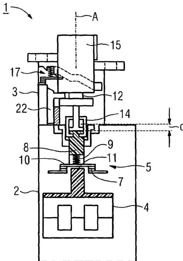
**ELECTROMAGNETIC SWITCHING DEVICE**
