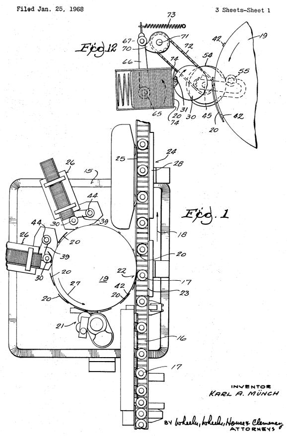
LABEL FEEDER WITH VARIABLE SPEED DRIVE
