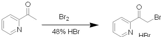
2 (2 プロモアセチル)ピリジン臭化水素酸塩は、3 (2 プロモアセチル)ピリジン臭化水素酸塩について用いられた方法にしたがって、2 アセチルピリジンから作成された、23 % 収率。
