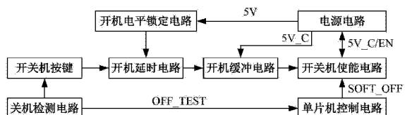
1. 开关机电路，其特征在于，包括开机按键、开机延时电路、开机缓冲电路、开关机使能电路、电源电路、开机电平锁定电路、关机检测电路以及单片机控制电路；
