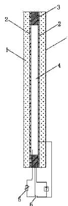
1. 一种基于太阳能和调光液晶的调光玻璃，其特征是它主要由双层透光玻璃面层(1)、液晶片(4)和太阳能薄膜电池(3)组成，双层透光玻璃面层(1)的内表面均粘结有EVA胶层(2)，呈框形结构的太阳能薄膜电池(3)夹装在两层EVA胶层(2)之间并沿透光玻璃面层(1)的四周布置，液晶片(4)也夹装在所述的两层EVA胶层(2)之间并位于太阳能薄膜电池(3)框架内；所述的太阳能薄膜电池(3)通过控制电路与蓄电池(6)的输入端相连，蓄电池(6)的输出端与液晶片(4)电气连接，在蓄电池(6)与液晶片(4)的连接电路上串接有调光电阻(5)。
