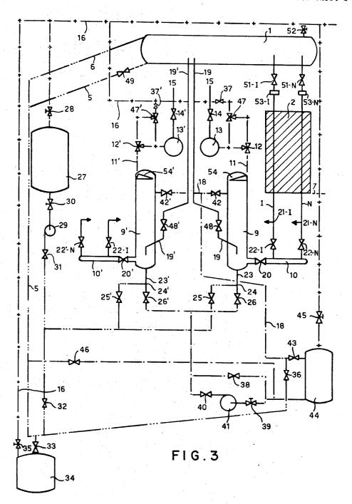
LIQUID POISON SAFETY SYSTEM FOR A NUCLEAR REACTOR
