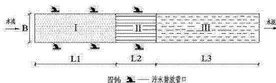
1. 一种工业化村镇污染河水净化与水环境生态修复方法,其特征在于,是将宽度为 B 的工业化村镇污染河段分隔成净水膜过滤段、生物棚过滤段、湿地布置段 3 个连续的不同区段作为污水处理单元,其中前 2 个河段为污水收集河段;污水首先进入长度为  $L_1$  的净水膜过滤段,自流至长度为  $L_2$  的生物棚过滤段,然后对整个污染河段按照  $0.015\text{kg}/\text{m}^2$  密度投放生物底质改良剂对河段进行底质改良,污水再流入长度为  $L_3$  的湿地布置段,之后再按照  $0.02\text{kg}/\text{m}^2$  的密度投放螺、蚬,按照  $0.5 \text{ 个 } / \text{m}^2$  的密度投放巨牡蛎对整个河段的污染河水实施底栖动物控养;其中净水膜过滤段长度  $L_1$  依据所属河段内的主要排污口设置,按该河段所收集的污水占治理河段收集的总污水量的 70% 确定,其它两段的长度分别为:  $L_2=0.3L_1$ 、 $L_3=1.5L_1$ 。
