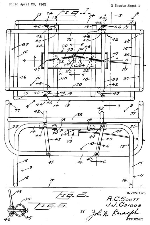
MOTOR DRIVEN OSCILLATING BASSINET SUPPORT
