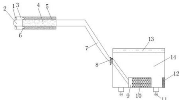
1. 一种新型印刷装置,包括握把(5)、风机(10)、箱体(14),其特征在于:所述握把(5)内部贯穿设置有吸尘管(4),所述吸尘管(4)左端设置有吸尘头(2),所述吸尘头(2)两侧设置有静电棒(3),所述静电棒(3)一端设置有静电刷头(1),所述握把(5)上开设有凹槽(6),所述静电棒(3)远离所述静电刷头(1)的一端与所述凹槽(6)插接,所述吸尘管(4)远离所述吸尘头(2)的一端设置有柔性管(7),所述箱体(14)一侧设置有箱口(8),所述箱体(14)内壁底侧设置有风机(10),所述风机(10)的吸入口设置有过滤网(9),所述柔性管(7)贯穿所述箱口(8)并延伸其内部与所述过滤网(9)固定连接,所述箱体(14)右侧设置有通风口(12),所述箱体(14)顶侧活动连接有箱盖(13),所述箱体(14)底侧设置有万向轮(11)。
