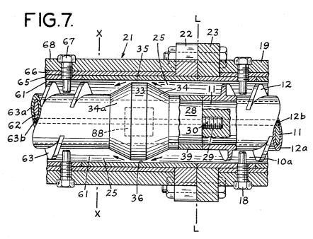
SCREW TYPE APPARATUS FOR DRYING MOIST **POLYMERIC MATERIALS**
