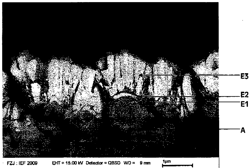
Fig. 2: Querschliff der Anodenstruktur gemäß Figur 1 und einer darauf aufgetragenen Elektrolyt-Struktur. A: Anode, E: Elektrolytschichtverbund (E1, E2, E3)..
