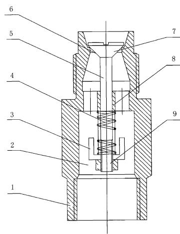
1、一种蒸汽喷头，包括设有轴向空腔的喷头套，其特征在于所述轴向空腔内设有与喷头套轴向相垂直的隔板，所述隔板中心设有中心孔，在中心孔周围的隔板上设有蒸汽通孔，所述轴向空腔内设有喷头芯，所述喷头芯由喷头杆和设置在喷头杆上端的喷头组成；所述喷头杆下端从中心孔穿过，喷头杆下端固定设有弹簧座，喷头杆上位于弹簧座和隔板之间套装有弹簧；所述喷头与喷头套上端之间设有相互配合的密封面。
