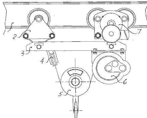
1. 电动葫芦起重机,包括行走机构、平衡小车、起升卷绕机构、联接梁和吊钩,其特征在于:起升卷绕机构与联接梁的一端下部连接,在与所述起升卷绕机构相对的联接梁的另一端的下部设有一个定滑轮,吊钩悬挂在滑轮与起升卷绕机构之间的钢丝绳上。
