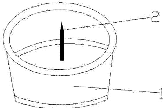
1. 一种烛台，包括底座(1)，其特征在于：在所述底座(1)上设有一插座(2)，所述底座(1)为中空结构，所述插座(2)为铁质的钉形结构。
