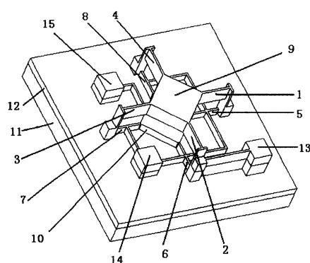
1. 一种微悬臂梁疲劳特性的电容检测结构，其特征在于该结构是在硅衬底（11）上设置一层氮化层（12），在氮化层（12）的上方悬空设有一组测试结构，该测试结构的中央为膜（9），在膜（9）的四个角上分别连接有第一悬臂梁（1）、第二悬臂梁（2）、第三悬臂梁（3）、第四悬臂梁（4），该四根梁的外端分别通过固定块固定在氮化层（12）的上方，在氮化层（12）的上表面设有一组与测试结构相对应的下电极，即第一下电极（5）、第二下电极（6）、第三下电极（7）、第四下电极（8）、第五下电极（10），第一压焊块（13）、第二压焊块（14）、第三压焊块（15）分别设置在氮化层（12）上，其中，第一压焊块（13）与膜（9）相连通，第二压焊块（14）分别与第一下电极（5）、第二下电极（6）、第三下电极（7）、第四下电极（8）相连通，第三压焊块（15）与第五下电极（10）相连通。
