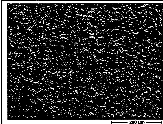
Fig. 25: Grobe Mikrostruktur (Strukturgröße ca. 20 μm – 60 μm).
