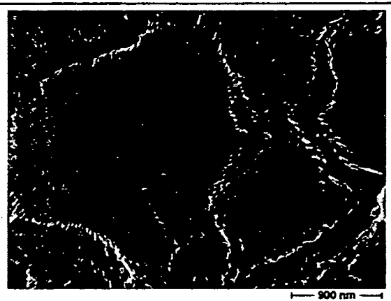
Fig. 28: Vergrößerung von Fig. 27. Nanostruktur (Strukturgröße ca. 10 nm – 50 nm).
