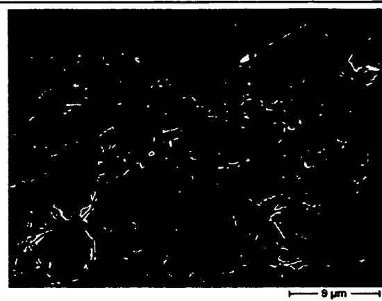
Fig. 12: Titanimplantat mit Strahlguteinschlüssen
