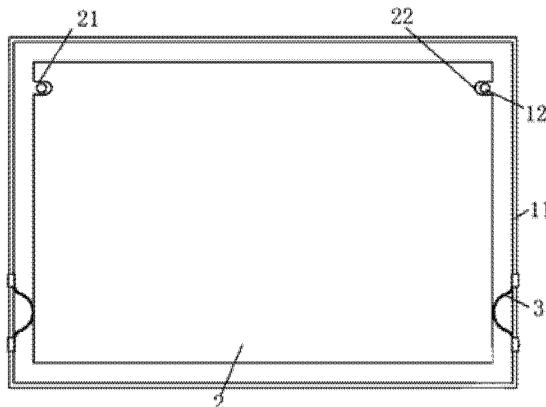
1. 液晶显示屏背光模组的固定结构，其特征在于，包括矩形的安装板和导光板，安装板四边上设有固定板，左右两边的固定板上均设有朝向内侧的缓冲定位件，所述缓冲定位件包括一弓形的金属弹片，金属弹片两边各连接一卡合件，所述卡合件为门形夹子，包括前夹片、后夹片和在上端连接两者的连接片，前夹片连接金属弹片，连接片的厚度等于固定板的厚度，金属弹片通过卡合件卡接在固定板上；导光板设于安装板中央，其左右两边和与其相对的固定板上的金属弹片顶端抵接，左右两边上还开有定位槽，安装板上设有定位柱，定位柱嵌在定位槽内，定位柱的直径等于定位槽的宽度，小于定位槽的长度，定位槽内端为与定位柱形状匹配的弧形。
