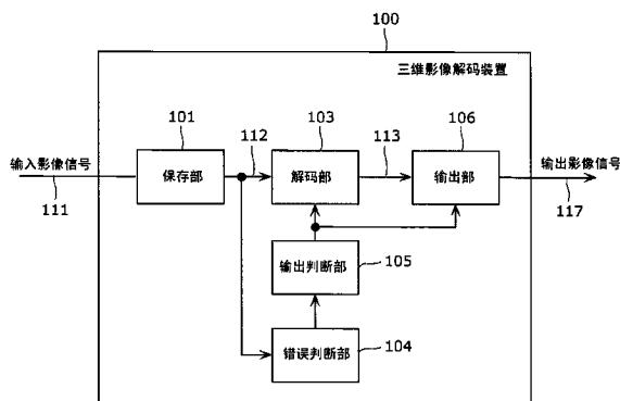
1. 一种三维影像解码装置,对将第1视点的影像信号编码而成的第1编码信号、和将与上述第1视点不同的第2视点的影像信号编码而成的第2编码信号进行解码,其特征在于,具备:
