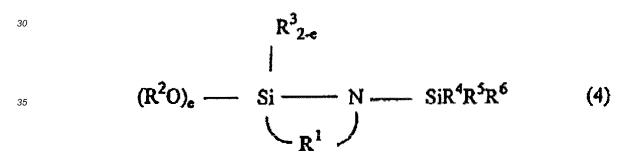
dans laquelle R<sup>1</sup>, R<sup>2</sup>, et R<sup>3</sup> ont les mêmes sens que définis pour la formule (1), R<sup>4</sup>, R<sup>5</sup>, et R<sup>6</sup> ont les mêmes sens que définis pour la formule (3), et e est 1 ou 2, et l'hydrolyse du polymère résultant.
