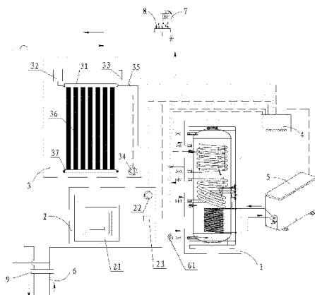
1. 一种真空管太阳能和空气源互补组合式供暖供热系统，其特征在于，包括保温水箱总成、真空管太阳能总成、供暖环路总成、空气源热泵总成、控制器总成、进水管路、用水末端、热水收集器和余热交换装置；
