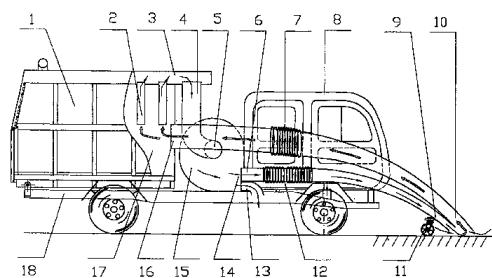
1、吹吸式扫路车，包括有汽车底盘，其特征在于汽车底盘上安装有风机和垃圾箱，风机抽风管和垃圾箱之间安装有过滤设备并互相联通，垃圾箱联通有吸尘管，风机排风口联接有吹风管，吹风管和吸尘管端口相邻。
