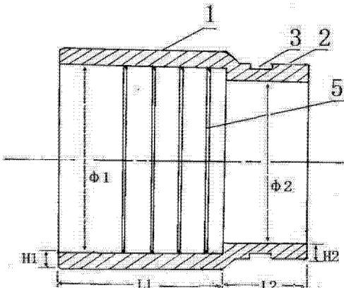
1. 外锁式塑料管道金属快速连接头,为圆筒状金属管件,包括:粗头段(1)和细头段(2);其特征在于:粗头段(1)的长度(L1)大于细头段(2)的长度(L2),粗头段(1)的内径( $\phi 1$ )大于细头段(2)的内径( $\phi 2$ ),粗头段(1)的壁厚(H1)等于细头段(2)的壁厚(H2)。
