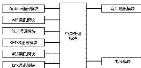
1. 一种智能家居网关,其特征在於,包括电源模块、中央处理模块、与公网通讯的网口通讯模块以及与不同的家居控制网络通讯的多个家居控制网络通讯接口,所述多个家居控制网络通讯接口包括:Zigbee通讯模块、WiFi通讯模块、蓝牙通讯模块、RF433通讯模块、485通讯模块、KNX通讯模块,所述中央处理模块分别连接所述电源模块、网口通讯模块、Zigbee通讯模块、WiFi通讯模块、蓝牙通讯模块、RF433通讯模块、485通讯模块、KNX通讯模块。
