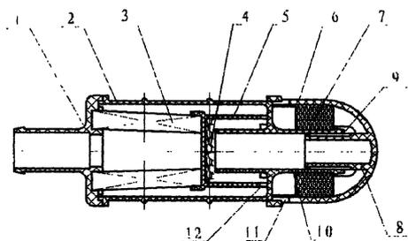
1、一种补气阀消噪过滤器，包括有外壳（1），壳体（2）、底盖（5）、外罩（6），其特征是壳体（2）的开口端插入外壳（1）顶端圆环内，右端肩部圆环内插有外罩（6）开口端，在壳体（2）肩部端面中心有与其同心的直圆筒（8），外罩（6）的内穹顶有内圆筒（8），内圆筒（8）外壁上开有直线槽（9），内圆筒（8）插入直圆筒（10）一端内，在直圆筒（10）一端外壁和外罩（6）内壁之间放置有泡棉芯（7），外罩（6）开口端沿裙边开有孔（11），呈杯状的底盖（5）位于壳体（2）内，其开口端边沿的圆周上有方齿孔（12），在底盖（5）内底部与直圆筒（10）的另一端之间有絮状丝网（4），底盖（5）底部外端面与外壳（1）的顶端环形槽内之间放有纸滤芯（3）。
