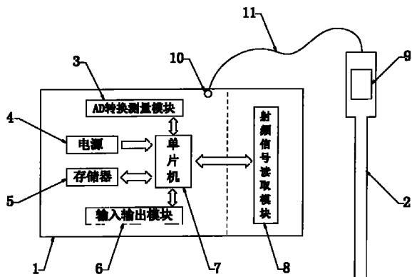
1. 一种电子标签温度传感器，包括测温仪表和温感探头，其特征在于：所述测温仪表内设有AD转换测量模块、电源、存储器、输入输出模块、单片机、射频信号读取模块和引线接口，所述温感探头内部设有射频存储卡，尾端通过传感器引线与引线接口连接，所述单片机分别连接AD转换测量模块、电源、存储器和输入输出模块，并与射频信号读取模块双向连接。
